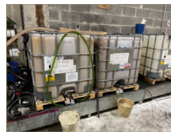
Das „verbrauchte“ Öl wird in IBCs geleitet (Setztanks). Freies Wasser und Ölschlamm sedimentieren am Boden ab und werden regelmäßig über die Entleerungsventile der IBCs abgelassen.
