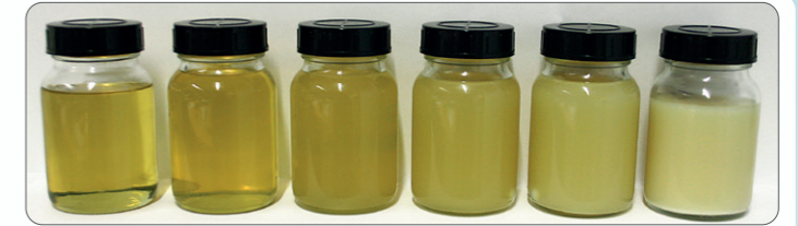
Hydraulikölproben mit unterschiedlichem Wassergehalt. Von links: 0,01 % – 0,03 % – 0,06 % – 0,1 % – 0,2 % – 2 % Wasser im Öl
